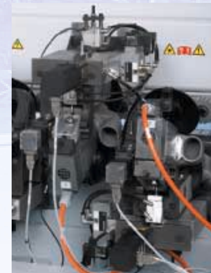
Multifunktionsfräsaggregat (optional) Flexibilität bei unterschiedlichen Kantenstärken und Profilen durch NC-Achsen.
