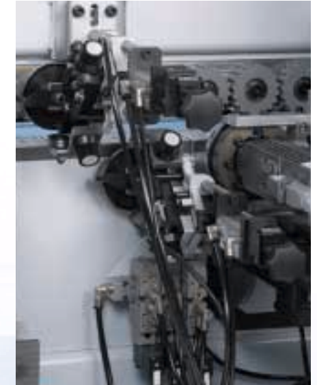
Ziehklingenaggregat Ziehklingenaggregat zum Glätten von Radien oder Fasen.
