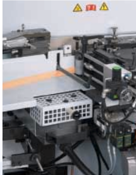
Magazin Rollen- und Fixlängenmagazin mit optischer Kantenüberwachung für sichere Materialzufuhr.
