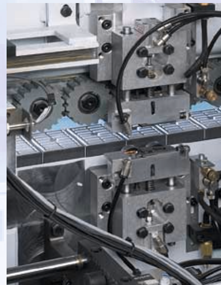
Flächenziehklingenaggregat (optional) Nachbearbeitung im Leimfugenbereich für maximale Sauberkeit.
