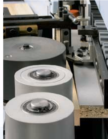
Druckzone Schwere Druckzone (bis 8 mm) für eine optimale Fugenqualität.
